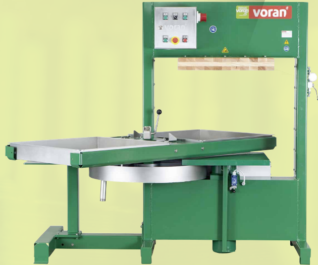
Packpresse 180P2 mit Hub-/Senkvorrichtung
