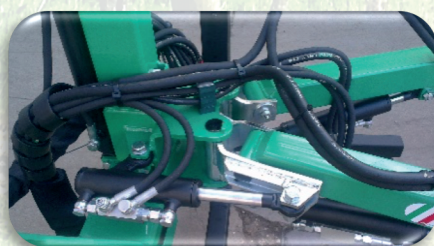
Cilindro per apertura delle testate andanatrici
