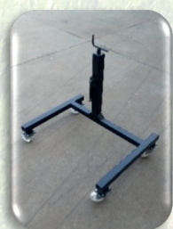
Cavalletto di sostegno regolabile in altezza
